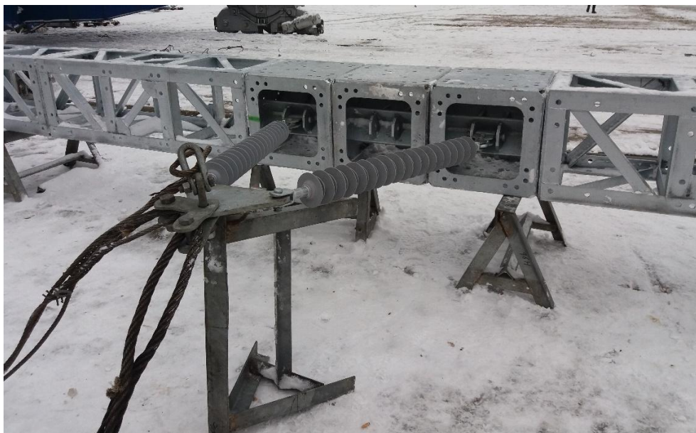
Rys. 8. Jednotrzonowy słup UMKW przygotowany do badań w skali naturalnej.
