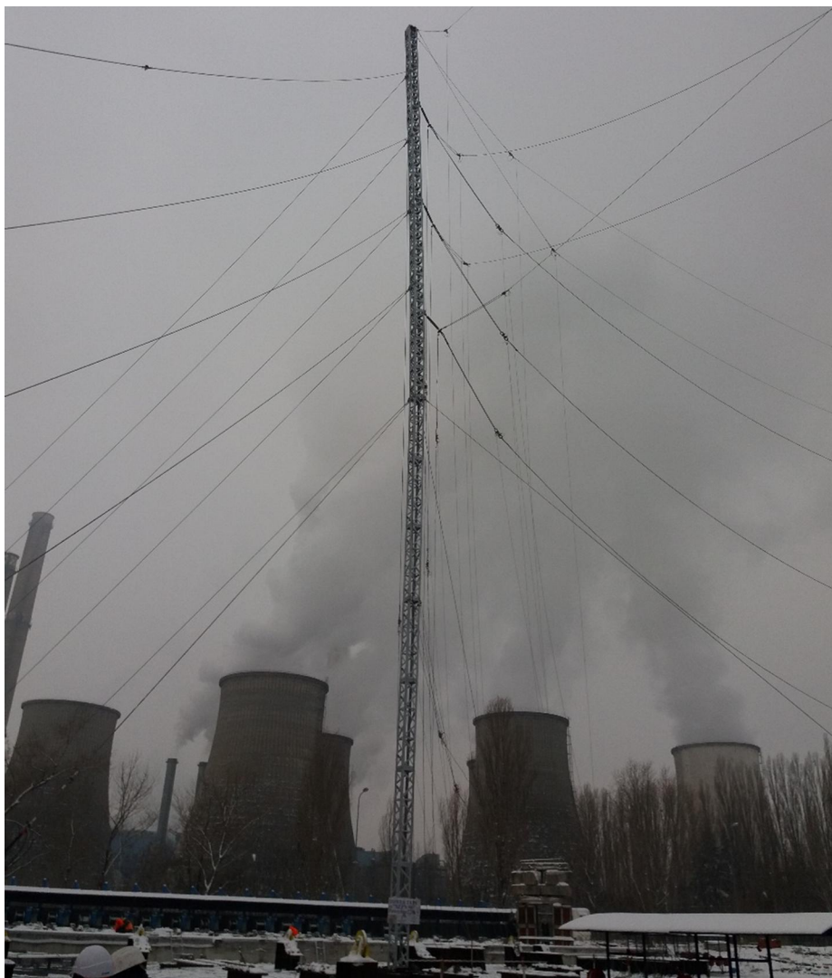
Rys. 9. Fotografia jednostronowego słupa UMKW podczas badań w skali naturalnej.
